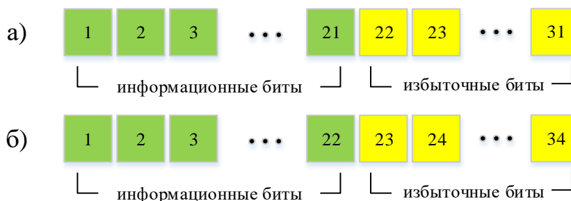
Рисунок 1. Графическое представление кодовой конструкции: а) кода БЧХ, б) модулярного кода
